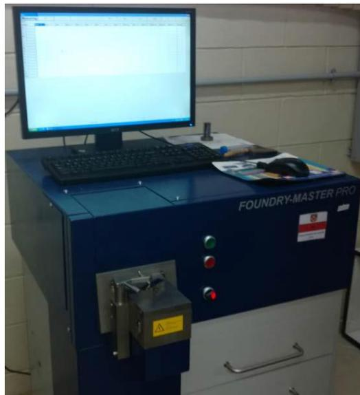
**Figura 21:** Espectrômetro de emissão óptica.
