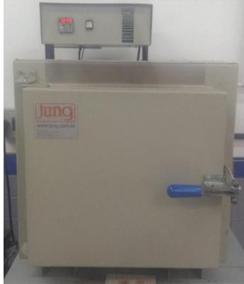
**Figura 22:** Forno tipo mufla, onde foram realizadas as etapas de tratamento térmico.
