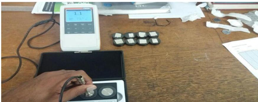
**Figura 23:** Calibração do ferritoscópio.
